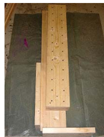
Bild 7. Fertiger Probekörper nach dem Ausnageln der Raster, links: Verklebung Furnierschichtholz (BSH/LVL) auf Brett-schichtholz (BSH/VH), aus diesen wurden, nach dem Aushärten und dem Entfernen der Nagelschrauben, die Prüfkörper (40 × 40 mm) herausgeschnitten
