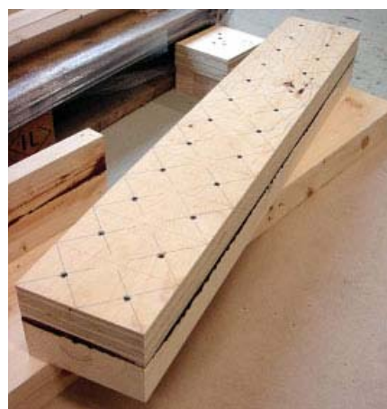
Bild 7. Fertiger Probekörper nach dem Ausnageln der Raster, links: Verklebung Furnierschichtholz (BSH/LVL) auf Brett-schichtholz (BSH/VH), aus diesen wurden, nach dem Aushärten und dem Entfernen der Nagelschrauben, die Prüfkörper (40 × 40 mm) herausgeschnitten
