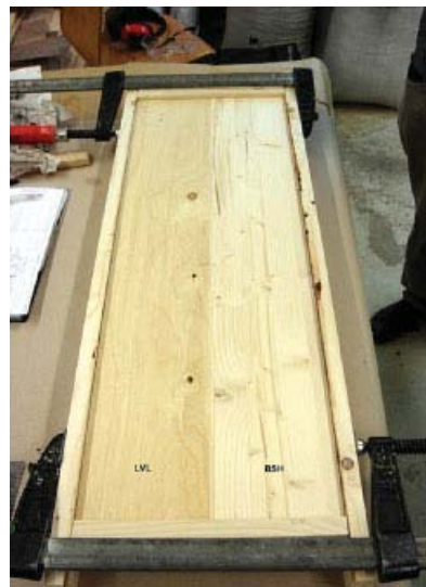
Bild 6. Herstellung der Verklebungen, links: Verklebung Furnierschichtholz auf Brett-schichtholz; rechts: Verklebung Vollholz (VH) auf Brett-schichtholz
