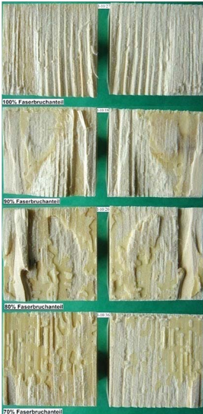
Bild 10. Verschiedene Faserbruchanteile; links: Klebung I (Epoxidharz Wevo EP20 VP/1); rechts: Klebung II (Phenol-Resorcin-Harz prefer 4094)
